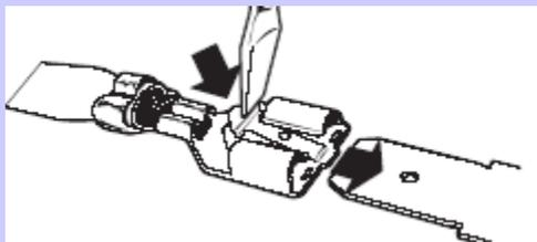
ELECTRICAL TERMINAL RELEASE/LOCKING TAB
